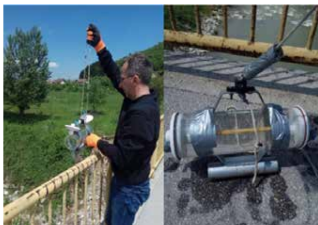
Mjerenje proticaja i pronosa nanosa na mostu u Vojkovićima na rijeci Željeznici 19.5.2019. g.
