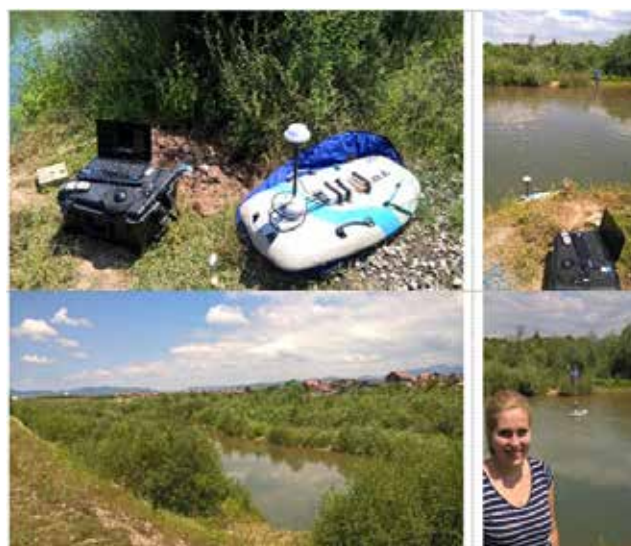
Mjerenje proticaja pomoću ADCP uređaja na profilu P12 (0+618.60) na rijeci Željeznici 4.7.2016. g.
