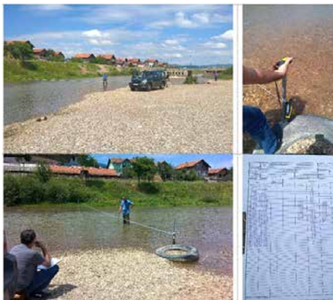
Hidrometrijsko mjerenje na profilu P3 (0+138.61) rijeke Željeznice 4.7.2016. g.
