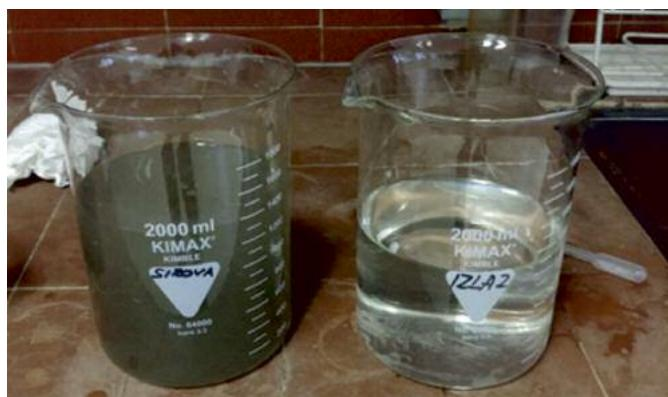
Slika 6: Ulazna sirova voda te prečišćena voda na izlazu postrojenja Butila (Sarajevo, 2021).
