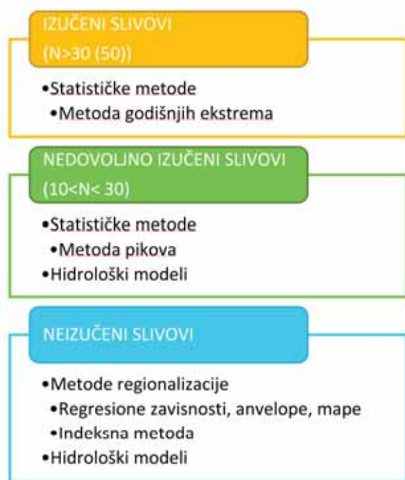
Slika 1. Prikaz metoda za određivanje velikih voda u zavisnosti od količine dostupnih podataka (N- broj godina osmatranja)
