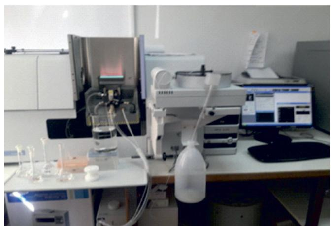
Slika 5. Atomski apsorpcioni spektrometar - Perkin Elmer AAnalyst 800
