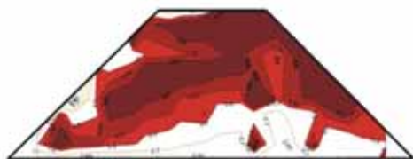
Slika 5. Proračunati potencijalni slomovi materijala prema Columbo-u za opterećenje sopstvenom težinom, uzgonom vode i hidrauličkim gradijentima iz FLUID modela
