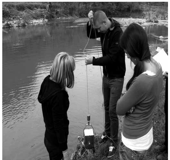
Slika 2: Uzorkovanje riječnog sedimenta pomoću Ekmanovog bagera
