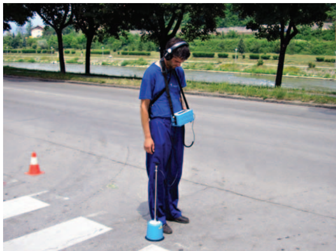
Slika 3.1. Otkrivanje kvara geofonom
