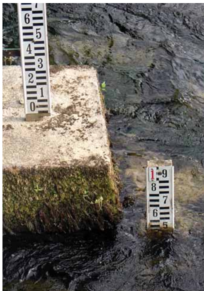
Mjerne letve za vodostaj na r. Unac
