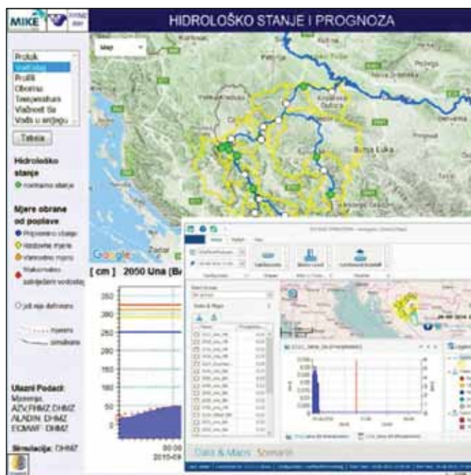
Slika 5: Prikaz sistema za predviđanje poplava u realnom vremenu
