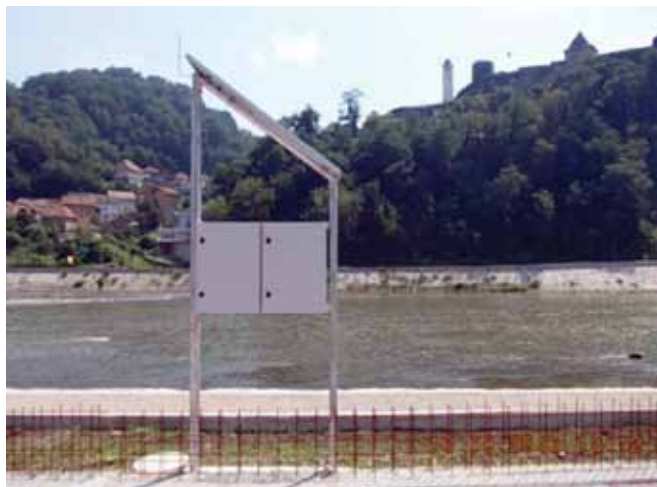
Slika 16.: Automatska stanica za mjerenje protoka srednjih i velikih voda rijeke Bosne – lokacija Maglaj grad
