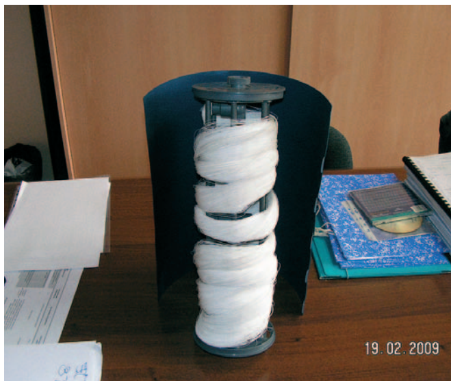
Slika 5. Svežnjevi (snopova) koji se omotavaju oko nosećeg uložka (cartridge).
