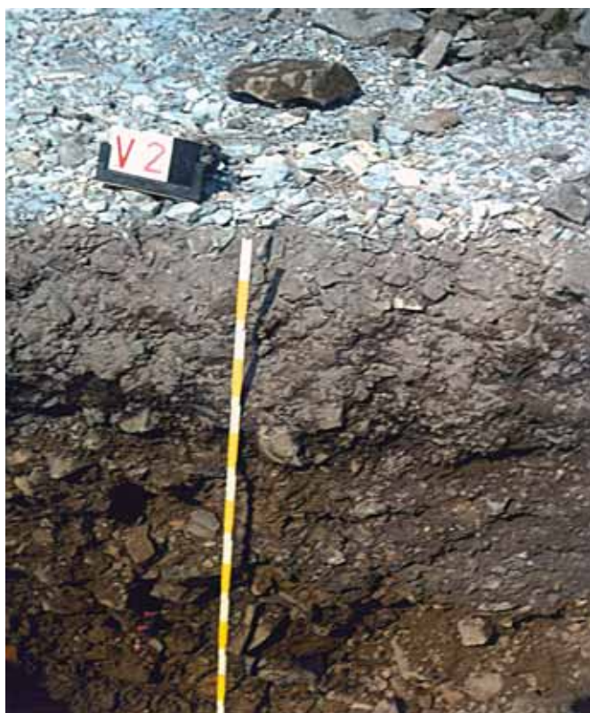
Sl. 14. Tuzla – Djurdjevik – rekultisol u profilu prisutna znatna količina laporovitog materijala koji se lako raspada pod uticajem atmosferilija.
