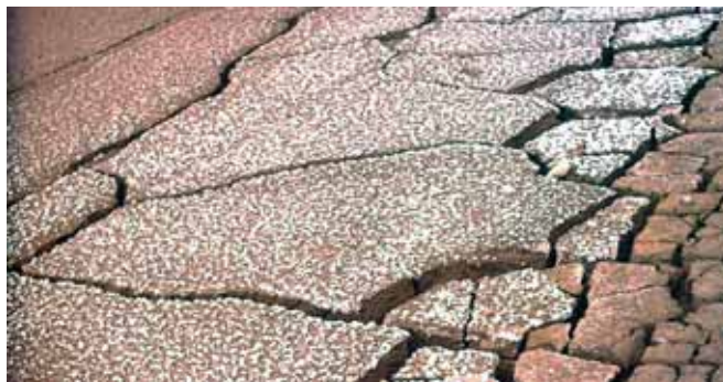
Sl. 7. Mostar – deponija crvenog mulja iz tvornice aluminijuma. Usljed prisustva sode i velikih količina aluminija zahtijeva indirektnu rekultivaciju.
