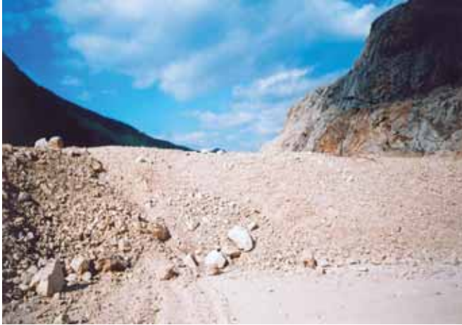
Sl. 8. Sarajevo – Lapišnica – oštećenja zemljišta nastala eksploatacijom krečnjačko-dolomitnih stijena (kamenolom) nastali usitnjeni krečnjačko dolomitni supstrat usljed prisustva skeleta takodje zahtijeva indirektnu rekultivaciju
