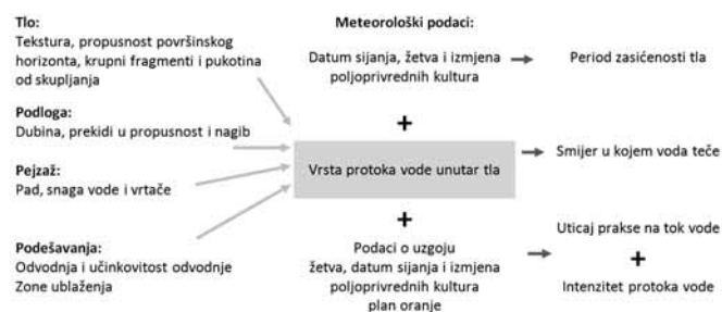
Slika 6 - Informacije potrebne za dijagnozu sliva i tla (Preuzeto od: Arvalis institut du vegetal)
