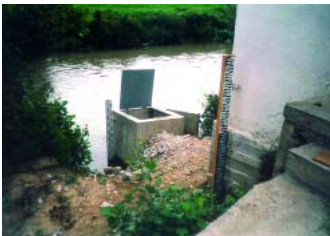
Na fotografiji je prikazan zaštitni šaht u koji je smješten višeparametarski senzor.
