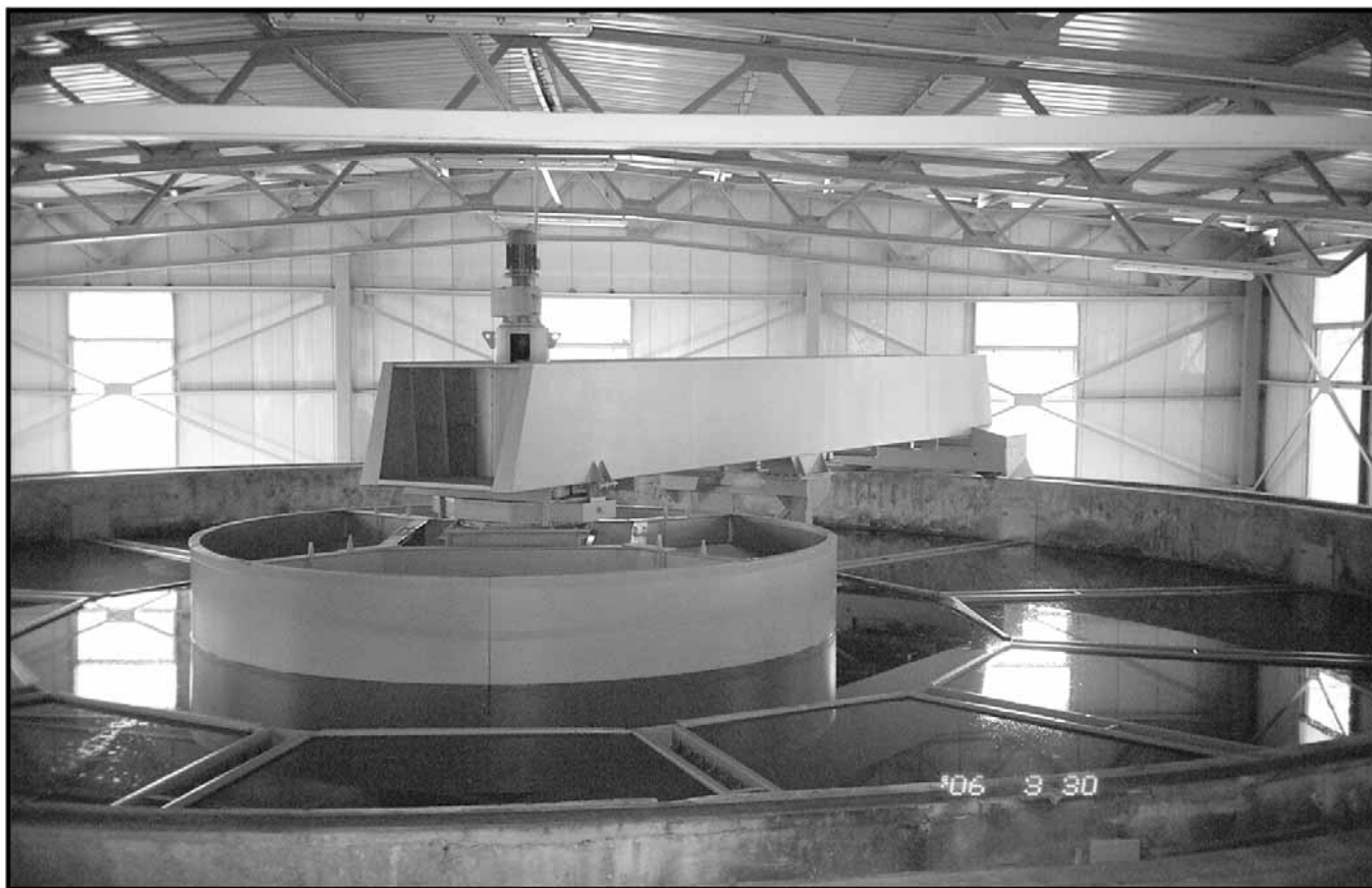
Slika br.6 – Dinamički taložnik
