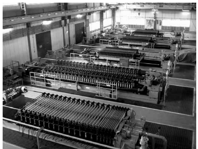
Slika 12. Filter prese za obradu mulja sa stanice za pripremu vode za piće u Japanu
