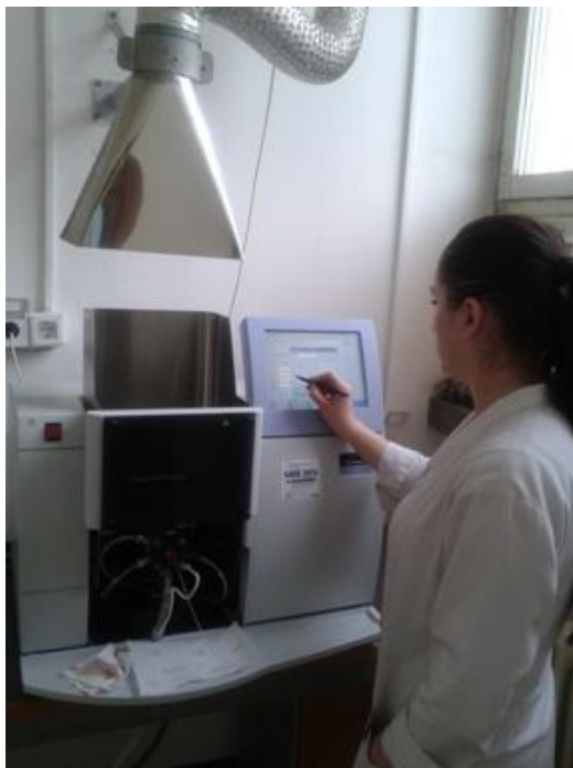
Slika 4. Određivanje teških metala na AAS „Perkin Elmer“
