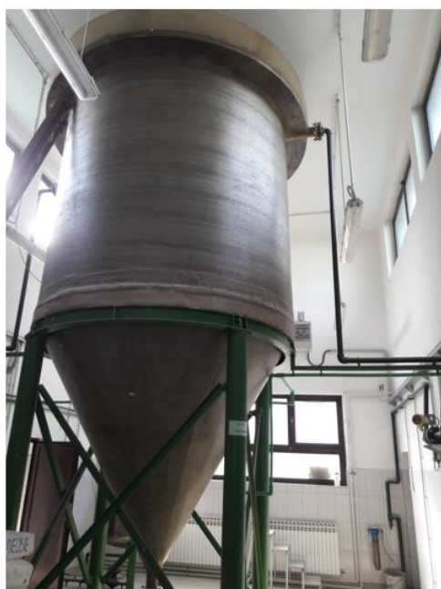
Vertikalni taložnik V=15 \text{ m}^3
