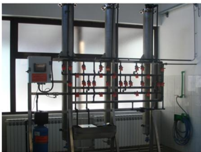
Jonoizmjenjivačke kolone za uklanjanje žive
